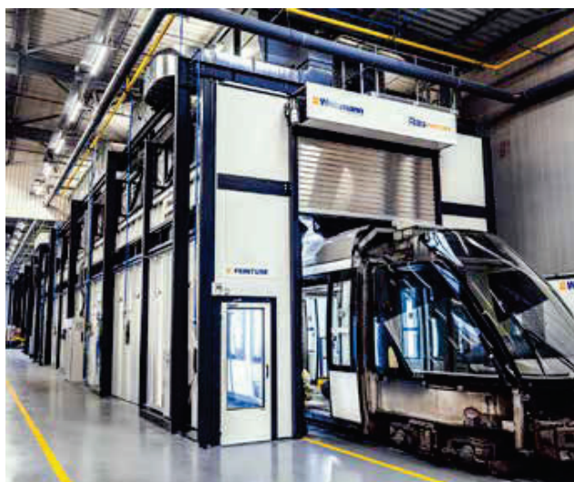
Weinmann Technologies a conçu la Modu-Factory, une cabine de peinture industrielle dimensionnée pour accueillir une rame de tramway entière, pour la Compagnie des Transports Strasbourgeois.
